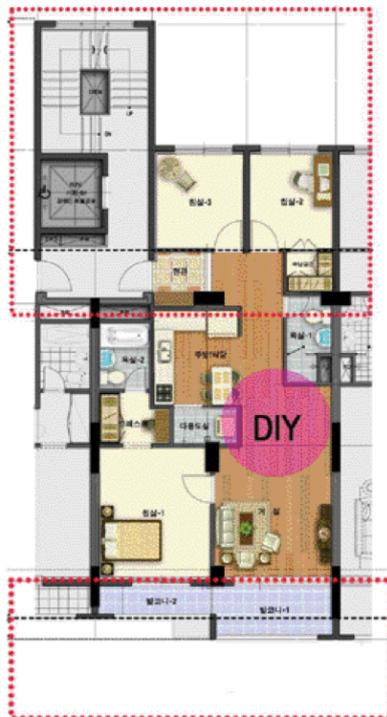
リビングとキッチンの中に DIY 空間<sup>※3</sup>が新設された。全面に設置されているバルコニーは 1.8M の余剰空間が追加され、空間の活用範囲が広がった。夫婦寝室には専用の浴室が設置されプライベート性を増した。キッチンと食堂は独立した空間となり、多用途室が追加された。二つの子供部屋は既存のバルコニーが専用面積に統合され広くなり、収納空間が設けられ狭小な空間から脱皮することが出来た。
